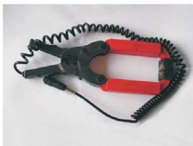
Imaxe dun analizador de redes eléctricas e dunha das pinzas amperimétricas que utiliza.
