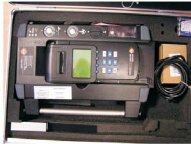
Imaxe dun analizador de gases de combustión e dunha sonda estándar do mesmo.
