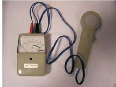
Imaxe dun luxímetro, aparato adecuado para a medición do nivel de iluminación.
