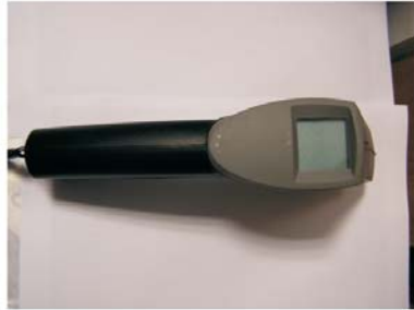
Imaxe dun termómetro por infravermellos, para medir temperaturas a distancia.
