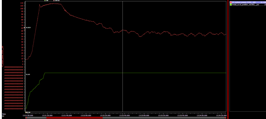
Figura 37. Funcionamiento a máxima potencia de la pila: potencia(rojo), acelerador(verde)
