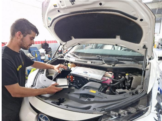
Figura 18. Sustitución del filtro de aire
