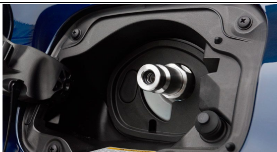
Figura 48. Boca de llenado de hidrógeno en un vehículo de primera generación. Se observa el conector específico para repostaje en estaciones HRS, diseñado para garantizar un acoplamiento seguro y estanco durante el suministro de hidrógeno comprimido
