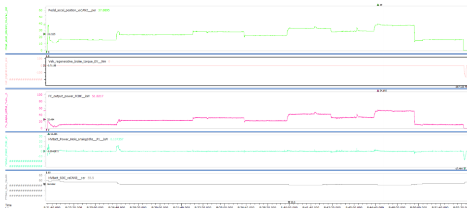
Figura 65. Funcionamiento del sistema pila / Batería (Velocidad de crucero) (II)
