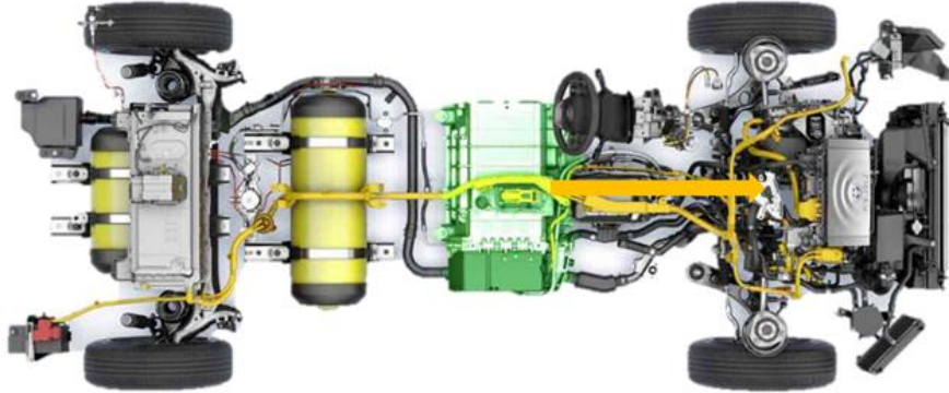
Figura 64. Funcionamiento del sistema pila / Batería (Velocidad de crucero) (I)
