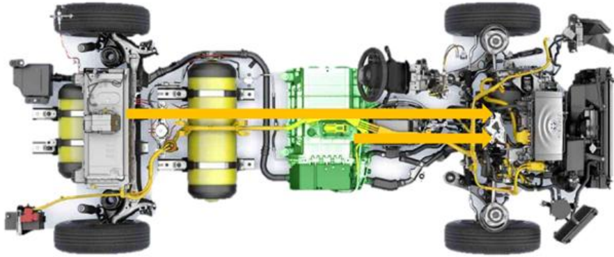
Figura 62. Funcionamiento del sistema pila / Batería (Aceleración) (I)
