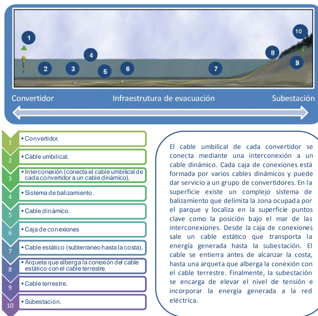
Figura 6: Componentes básicos de un parque marino. Fuente: Clúster Energía, EVE-Ente Vasco de la Energía
