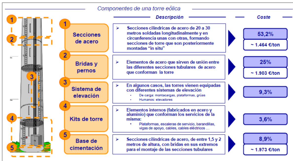
Figura 2: Componentes torre eólica. Fuente: Sodercan/Europraxis
