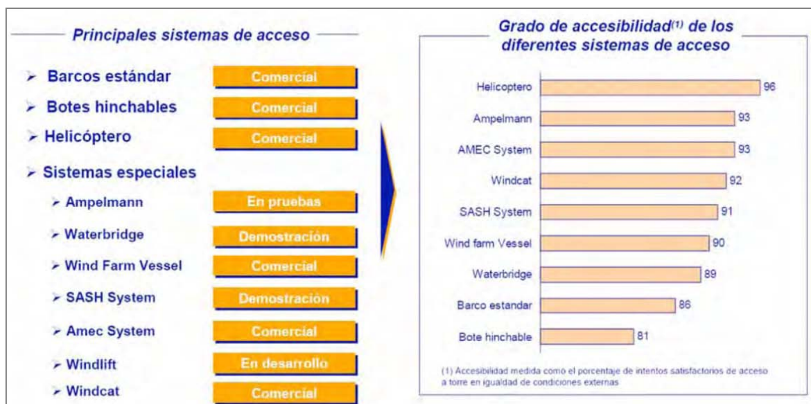
Figura 5: Principales sistemas de acceso y grado de accesibilidad de los sistemas existentes. Fuente: Sodercan
