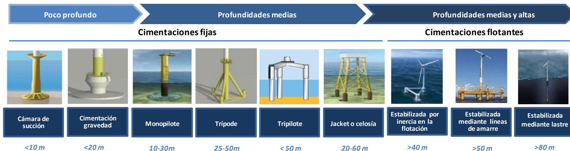
Figura 11: Tipos de cimentaciones y profundidades típicas. Fuente: elaboración propia
