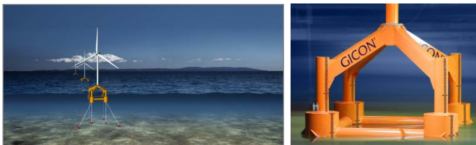
Figura 47: Esquema del prototipo GICON. Fuente: www.gicon-sof.de
