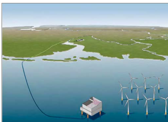
Figura 23: Esquema de la conexión eléctrica de un parque eólico offshore. Fuente: Stendius, 2007
