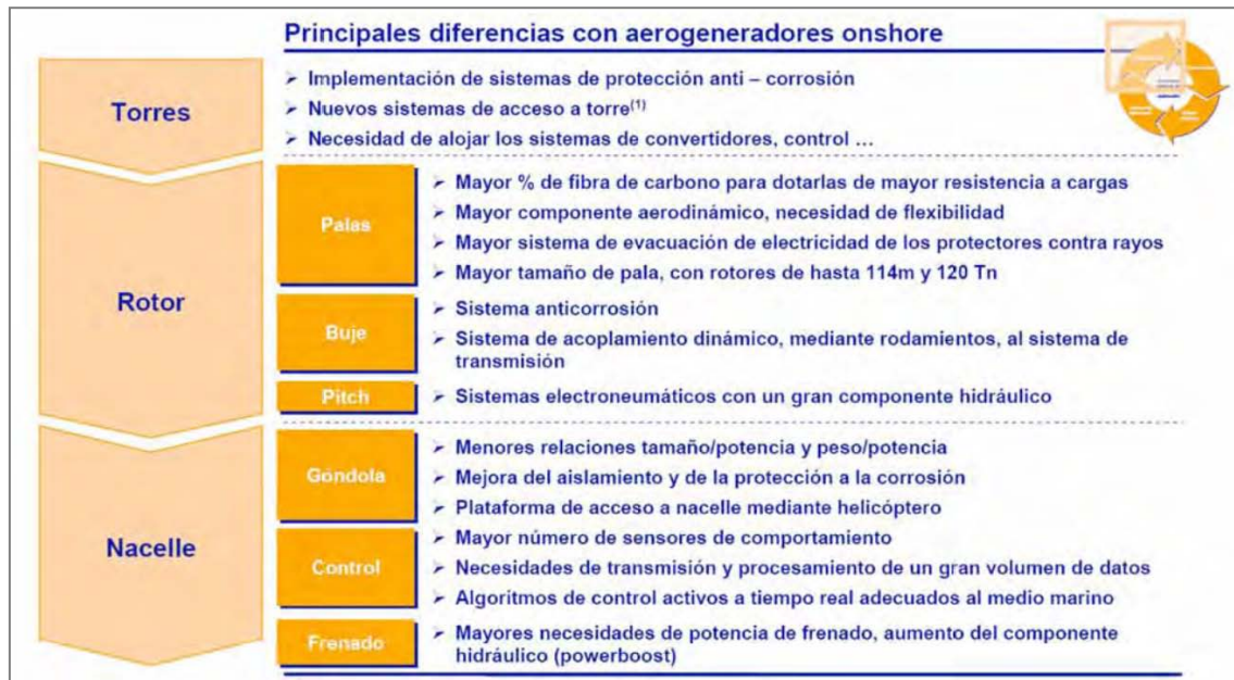
Figura 4: Principales diferencias con aerogeneradores onshore. Fuente: Sodercan/Europraxis
