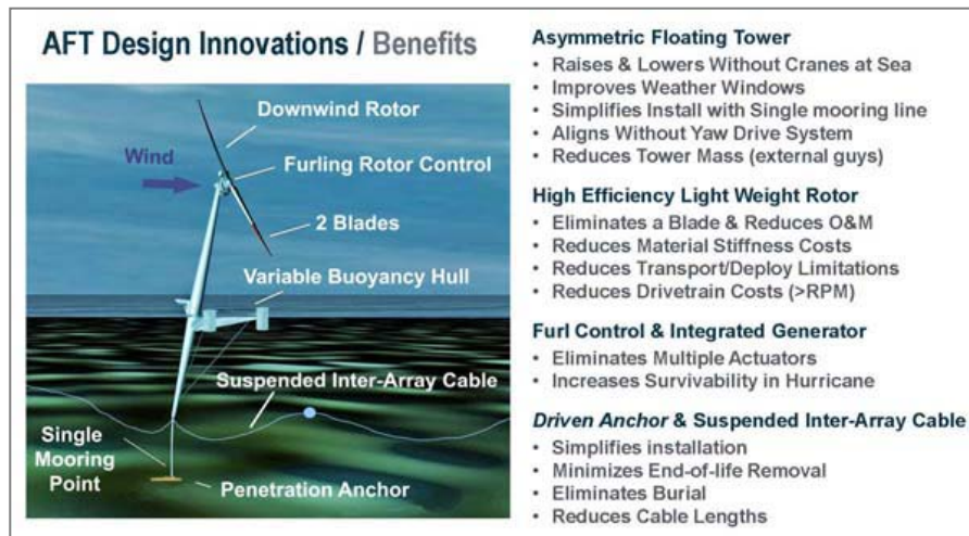
Figura 48: Esquema sistema AFT. Fuente: Nautica Windpower.
