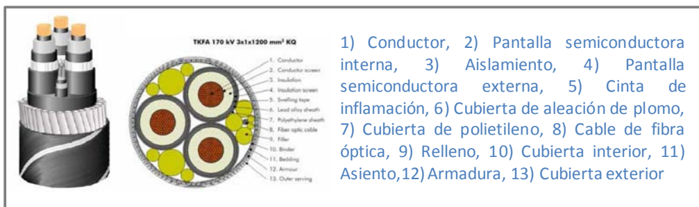
Figura 26: Composición del cable eléctrico submarino. Fuente: proyecto EquiMar 17
