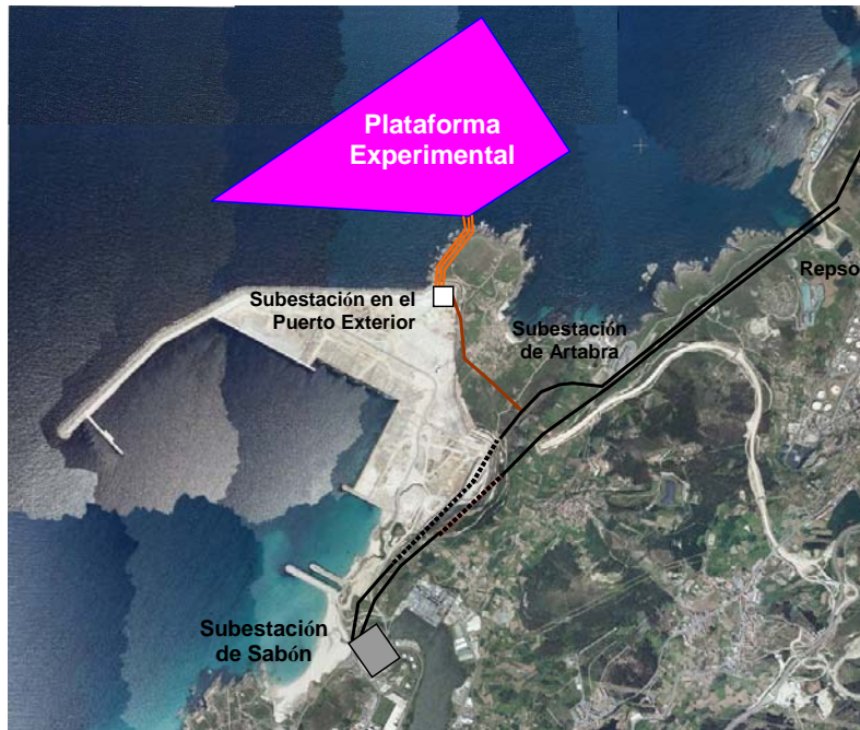
Ilustración 29: Conexión en T a línea Sabón-Artabra con línea aérea desde la Plataforma Experimental
