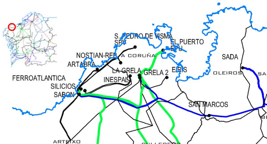
Ilustración 19: Esquema de la Red de Alta Tensión ( U \geq 66kV ) en el entorno de la subestación de Sabón
