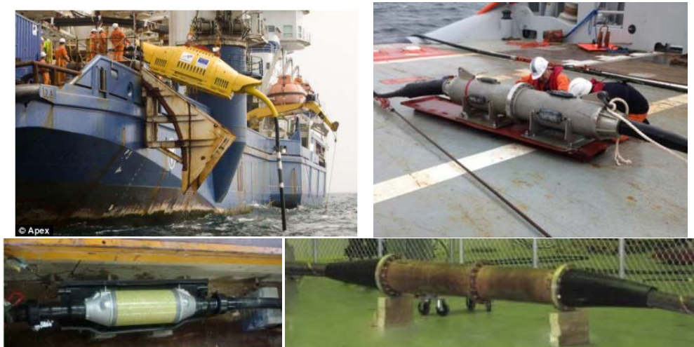
Ilustración 41: Ejemplos de conectores de cables marinos
