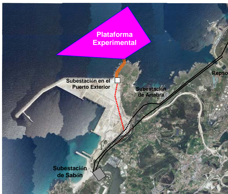
Ilustración 28: Conexión en T a línea que cruza el Puerto Exterior desde la Plataforma Experimental
