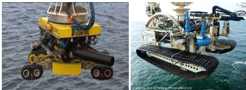
Ilustración 38: Equipos para enterrar cables en fondo arenoso [capjet trenching system Nexans & ???]
