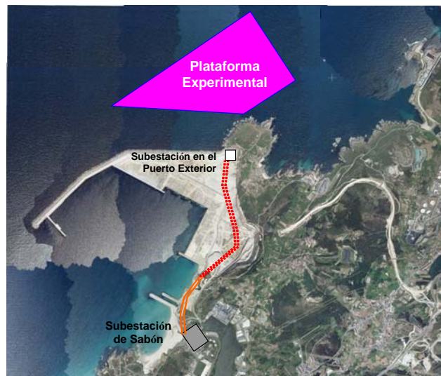
Ilustración 124: Fase I, construcción de doble circuito Sabón/Subestación P.Exterior y P.Experimental
